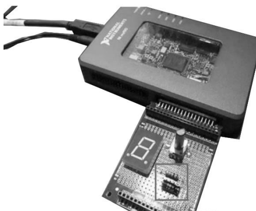
图 6-19 将 RC 电路连接到 myRIO 上（此处扩展板上的七段数码管和电位器并不使用）
