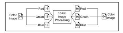
IMAQ ExtractSingleColorPlane 或 IMAQ ExtractColorPlanes 模块用于将彩色图像的红,绿,蓝,色调,饱和度,强度,流明,或彩色图像的值平面提取为一个 8-bit 图像。
