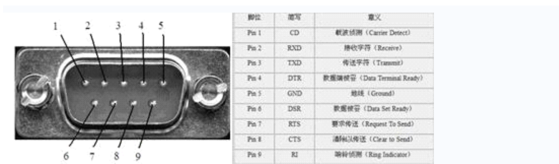
图 11-3 RS232-C 接口连接器定义
