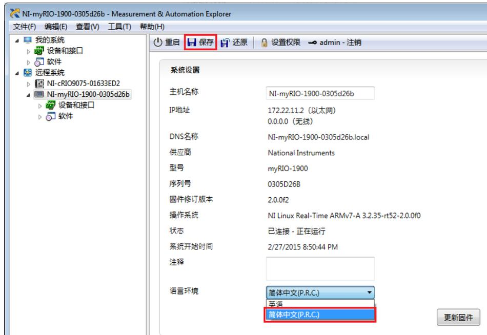
用户除了可以在 NI MAX 中看到 myRIO 的系统信息并对其进行多方面的配置修改之外，还可以通过 NI Network Browser（网络浏览器）来查看所安装的软件。如果没有桌面快捷方式的话可以在**开始 » 所有程序 » National Instruments** 中找到该应用，双击后会打开用户的浏览器，即时搜索网络上连接的所有设备，单击 myRIO 的虚拟 IP 地址打开系统配置窗口，类似于在 NI MAX 中所看到的界面，但目前只能在该浏览器窗口查看所安装的软件信息，配置修改等操作还是需要 NI MAX 中完成。
