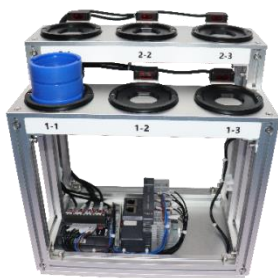
图10 钢轮组件放置位置图 图11 中间法兰、输出法兰井式供料图
