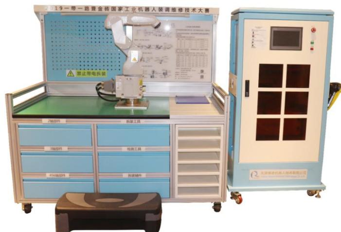
图3 工业机器人装调维修技术竞赛平台
