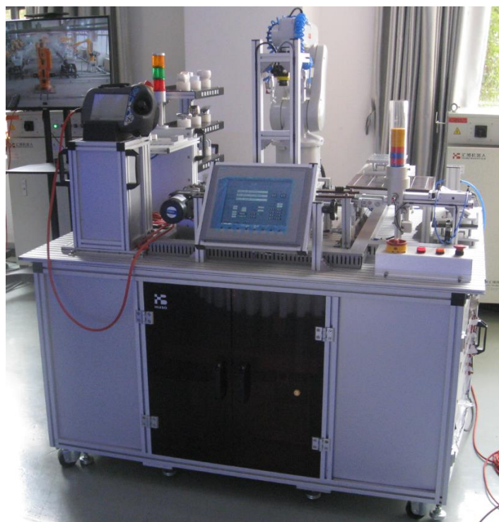
图 HB-ASX01 桌面型多功能 ABB 工业机器人实训平台
